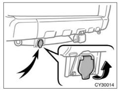
TOWING CONNECTOR FOR TRAILER LIGHTS
